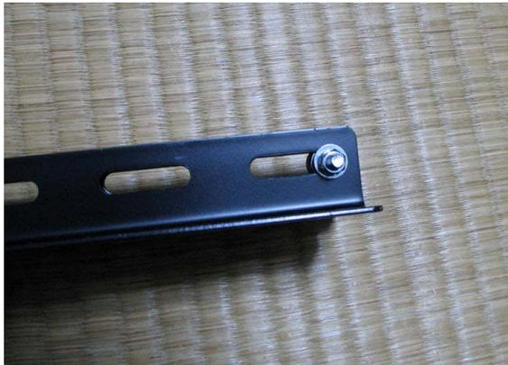
前ページで曲げ板を取り付けた反対側の最も端の穴に、ボルトとスペーサーを通して固定する。
