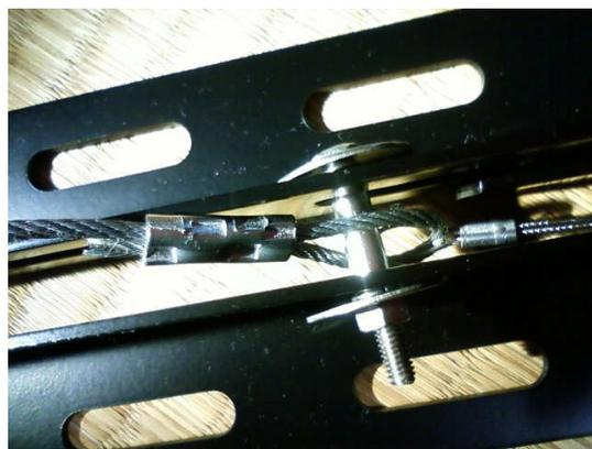
カラーアングルのドア外側方向から4つめの穴に、ストッパーを取り付ける。
