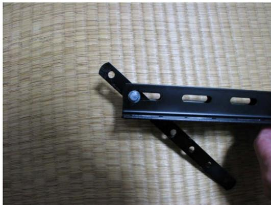
**カラーアングルの最も端の穴に曲げ板を取り付ける。
